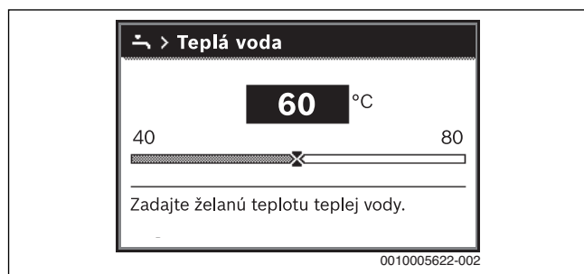
Obr. 9 Nastavenie maximálnej teploty teplej vody
